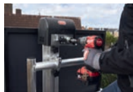
Bedienung mit Akkubohrer
