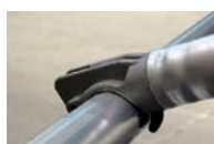
Gepresste Verbindung zwischen Klaue und Strebenrohr.
