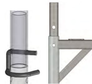
Figura 27: ganci di chiusura con spinotti di collegamento
