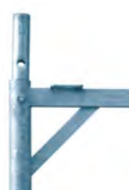
S/D70 - 4 Spinotti avvitati, nodo del telaio con ferro piatto, traversa in tubo rettangolare
