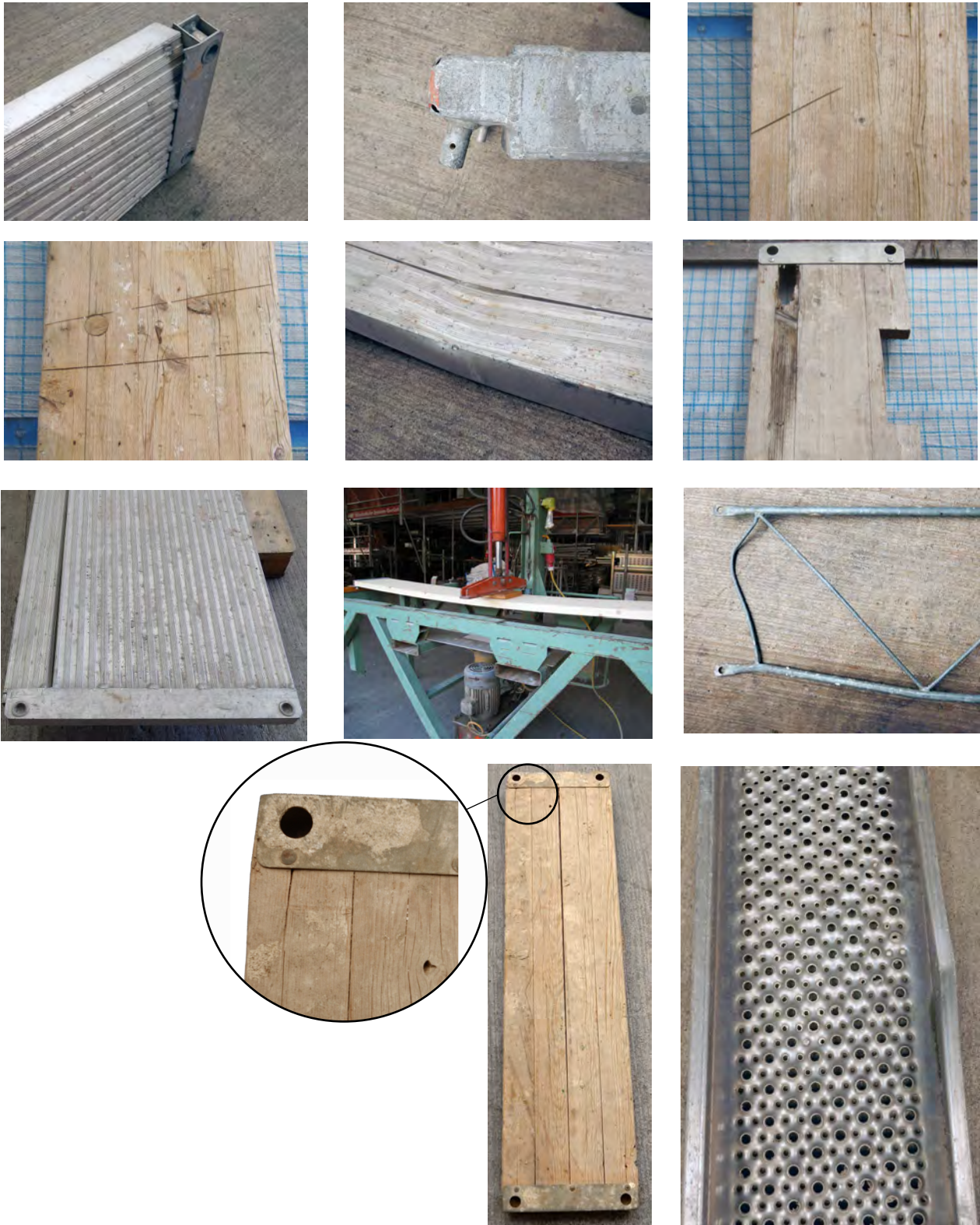
Figura 60: tavole di ponteggio difettose
