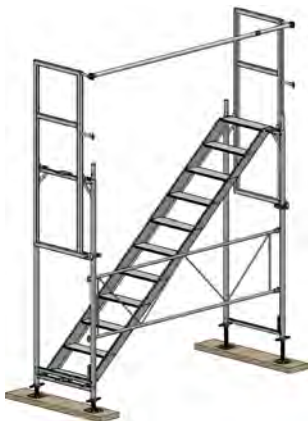
Figura 4: Parapetto frontale provvisorio (PSSG)
