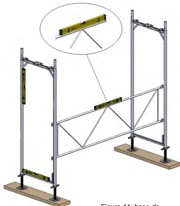
Figure 11: base de l'échafaudage
