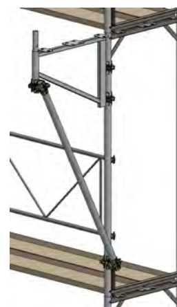
Figure 41: extension 70 cm du pont d'échafaudage avec soutien diagonal
