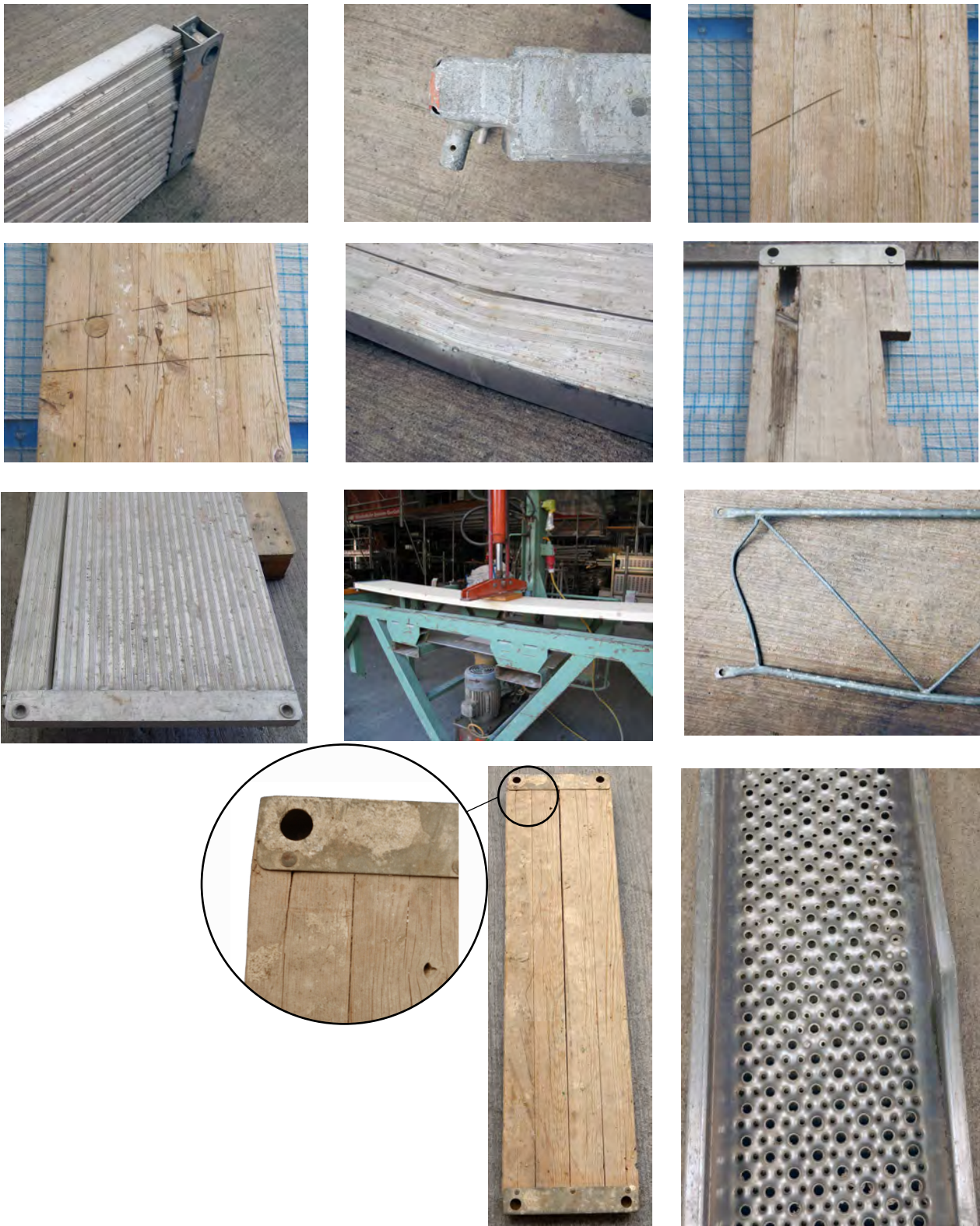
Figure 60: plateaux d'échafaudage défectueux
