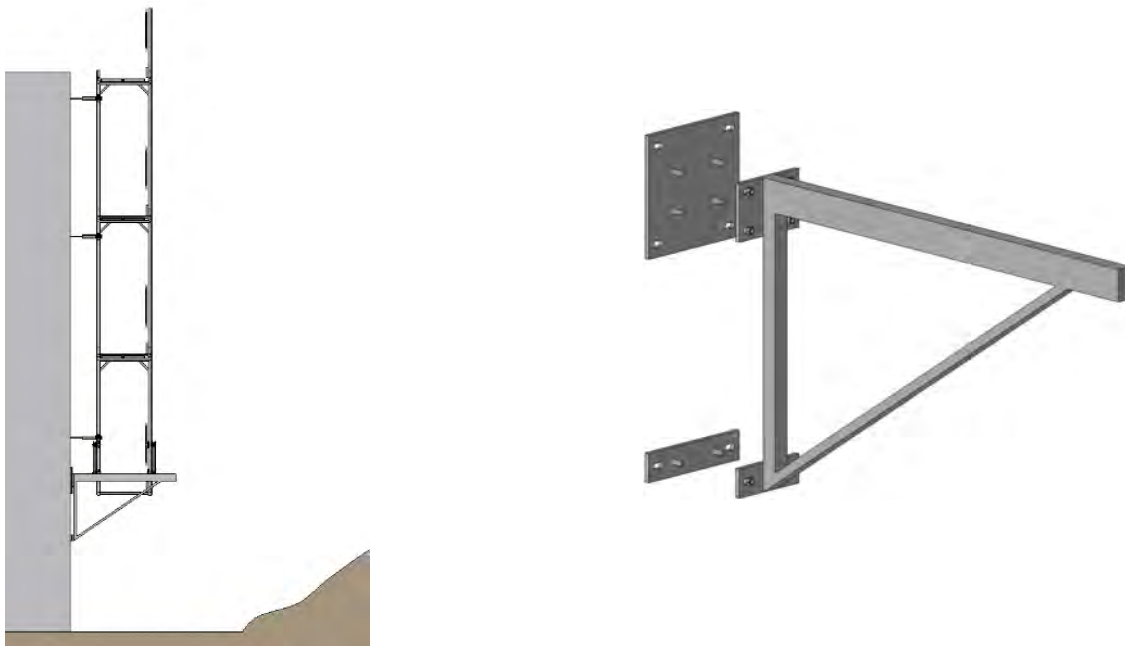
Figure 57: consoles pour charges lourdes avec des plaques murales
