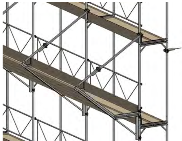
Ansicht mit Aufhängungen bei besonderen Anforderungen
