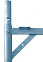
L/LD70 - 4 geschraubte Zapfen, Flacheisen mit Loch im Spickel, Rechteckrohr für Plattenauflage
