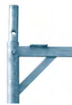
S/SD70 - 4 geschraubte Zapfen, Flacheisen im Spickel, Rechteckrohr für Plattenauflage
