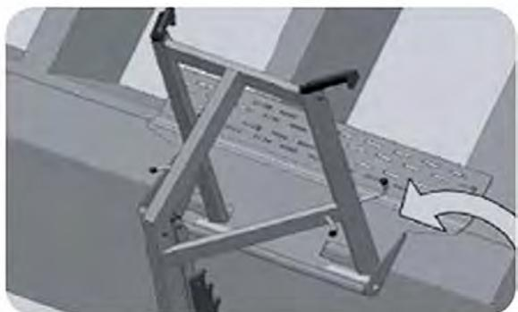
5. Sichern Sie die Sicherungsstange mit 2 Splinten.
